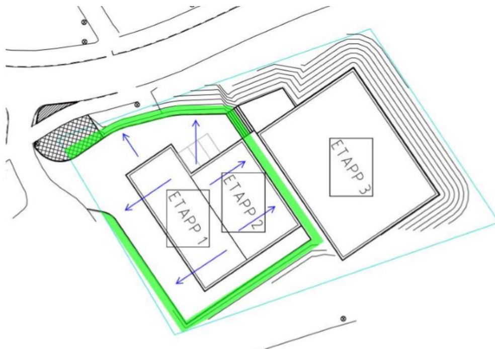
Förslag till systemlösning med placering av svackdike med slänt i grönt och flödespilar i blått.
